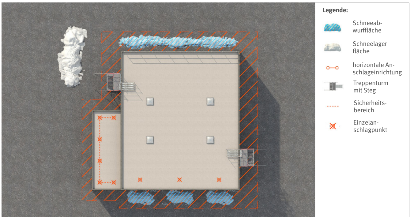
Abb. 4 Darstellung der Sicherheitszone, des Zugangs zur Dachfläche, der Abwurfstellen und der Schneelagerfläche
