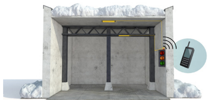
Abb. 8 Messung mittels Dehnmessstreifen
